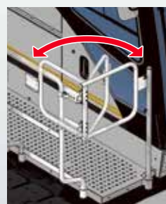
ハウス上面ハンドレールゲート部すべてを、チェーンからパータイプ（自閉式）へ変更
